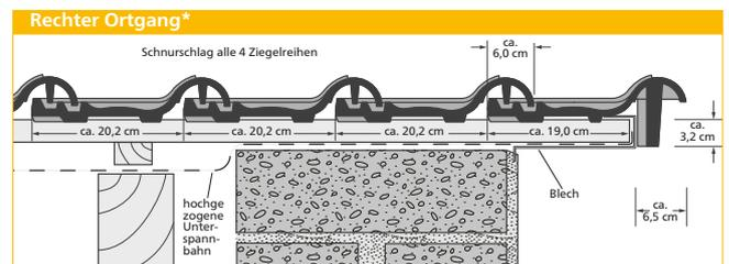
\* Bei flacher Dachneigung ist das Verschraubungsloch im Ortgang dauerelastisch (z. B. mit Spenglerschrauben) abzudichten.
