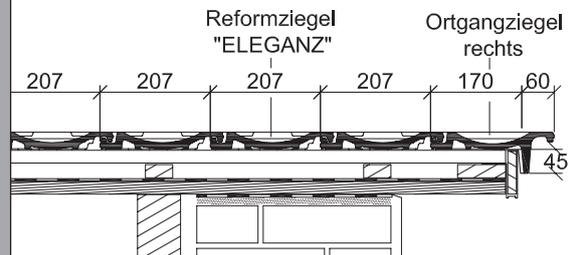
\* Die dargestellte technische Zeichnung ist nur ein Konstruktionsbeispiel. \*\* Laut dem Regelwerk des ZVDH soll bei Ortgangziegeln der Abstand zwischen Innenkante Ortganglappen und Außenkante Giebelwand bzw. Außenkante Bekleidung mindestens 1 cm betragen.
