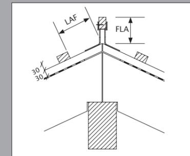
LAF = Lattenabstand zum Firstschnittpunkt (in mm)
