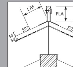
LAF = Lattenabstand zum Firstschnittpunkt (in mm)
